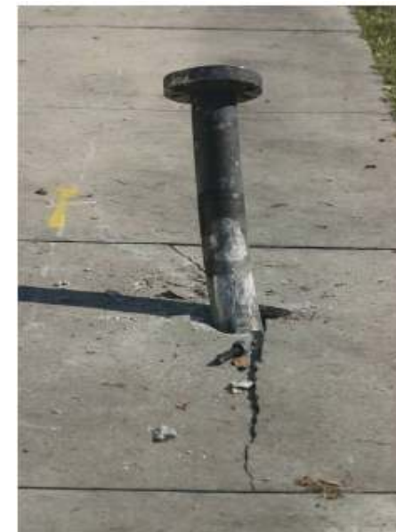
Brokstuk van een reactor van T2 laboratorium (Florida) na het plaatsvinden van een explosie op 20.12.07
